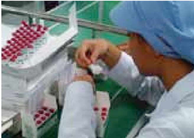
Flacons d'anatoxine tétanique avec pastille de contrôle du vaccin, en cours d'emballage, dans une usine de production de vaccins à Bandung, Indonésie.
